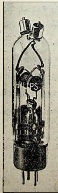
1. Een magnetron in de nieuwste uitvoering. De anode, van vierkante doorsnede, is onwrikbaar bevestigd door middel van twee kwartsstaven. De anode is verdeeld in een even aantal deelen, welke groepsgewijs in de lamp zijn verbonden.
